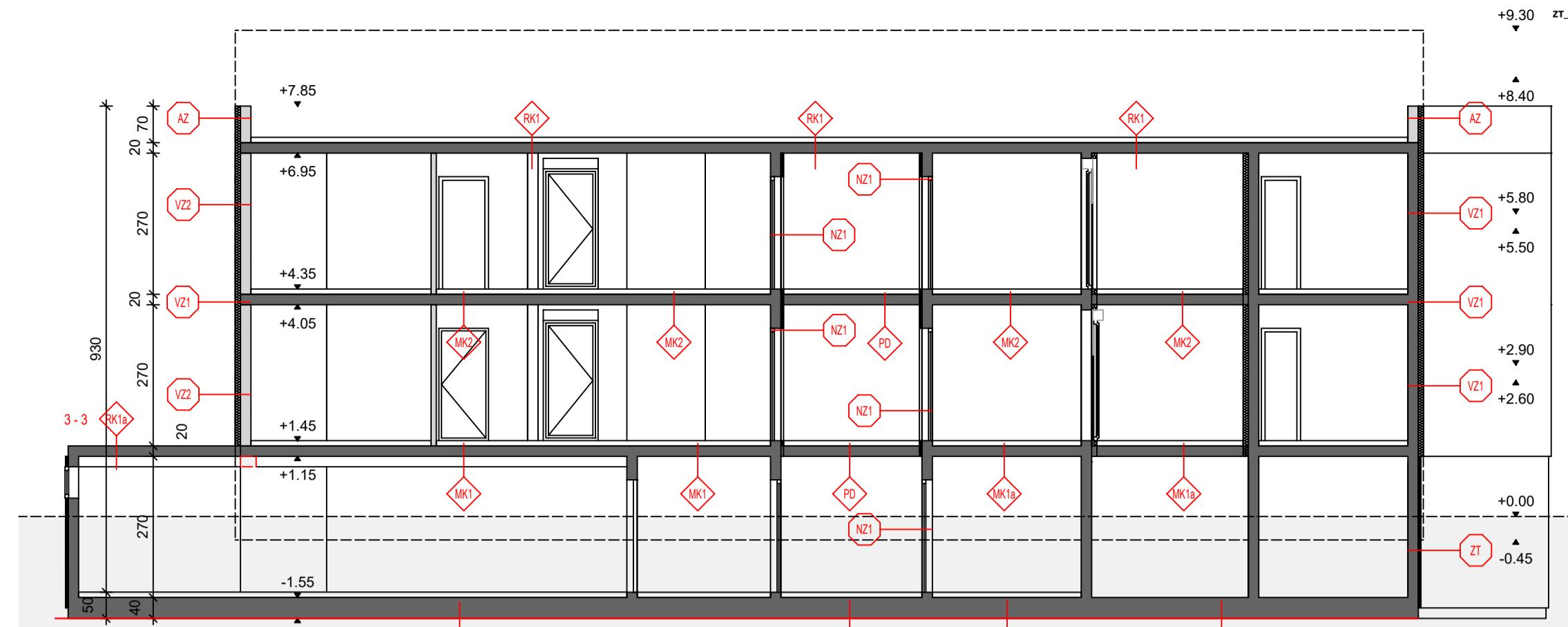
Zid u tlu, U=0,38 W/m2K, (Udop=0,40 W/m2K)
